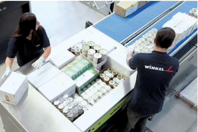
Die Winkel Fast-Pick-Station im Einsatz: Der Ladungsträger wird immer auf der optimalen Höhe positioniert. Der Mitarbeiter muss die Waren nicht mehr heben, nur noch horizontal verschieben – eine enorme Erleichterung. Foto: Winkel GmbH
